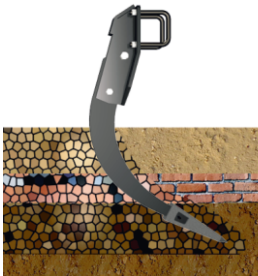
Cinzel semiflexible que afloja por vibración con un bajo consumo de potencia. Gran distancia entre la punta del cinzel y el marco (800 mm.) para mayor profundidad de trabajo.
